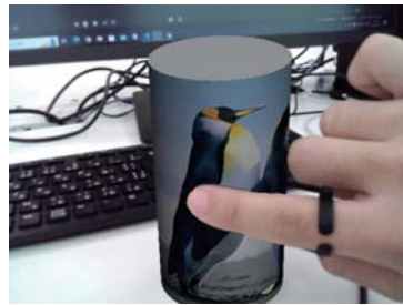
AR空間において鳥の映像を追加された有形物体に触れる様子。当社が開発した触感サンプルを介して触れることでよりリアルな材質感を再現（埼玉大学小室研究室にて撮影）。
