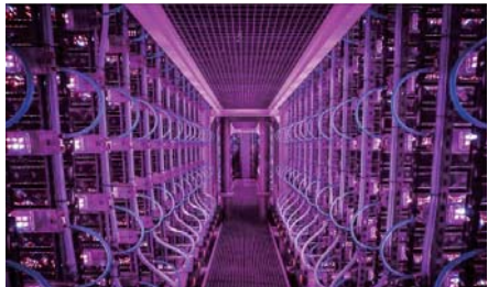
LEDを用いた独自のフォトバイオリアクター（VAXA社）
