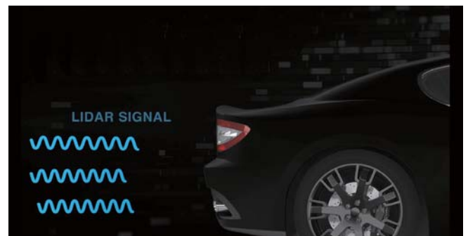
LIDAR信号の近赤外線は、外装塗料のカーボンブラック顔料に吸収され、信号応答性が著しく低下
