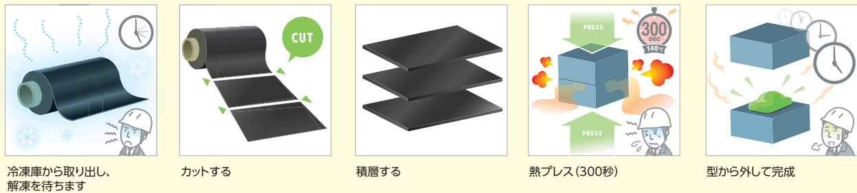
【図-2】従来型プリプレグシートによるCFRPの製造工程
