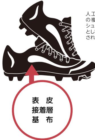
人工・合成皮革は何層もの複層構造で、スポーツシューズを構成するパーツとして供給、手作業で接着される。
