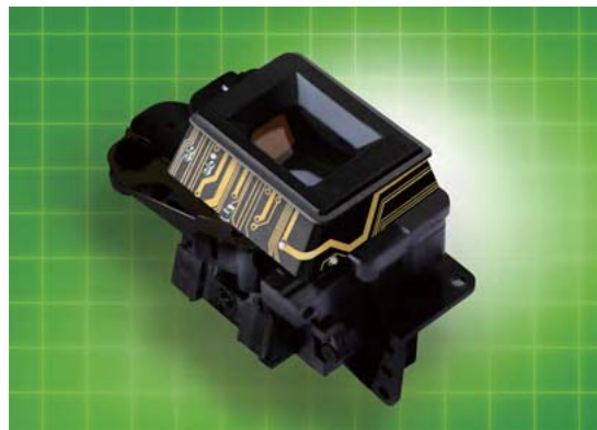
成形回路部品（イメージ）：従来のプリント配線板とは異なり、基板やハーネスが不要となることから、より小型化、軽量化、薄型化が可能となり、今後の市場拡大が期待される。
