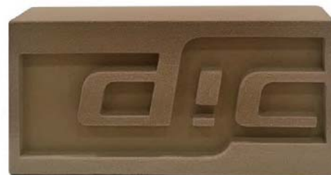
当社フェノール樹脂バインダーを使用し3Dプリンターで作成した砂型サンプル
