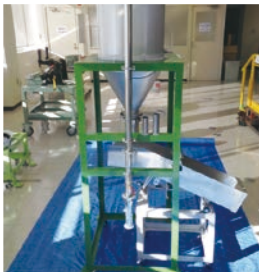
巡回教育用に小型化した 「静電気の発生と抑制体感機器」
