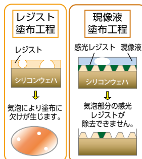
気泡による集積回路の形成不良
