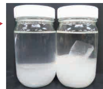
涂布HYDRECT的纸(左)溶于溶液，聚乙烯覆膜纸(右)无法溶解。
